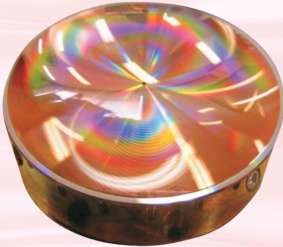
試作例1 ナノ加工機で加工した50φフレネルレンズ用金型
